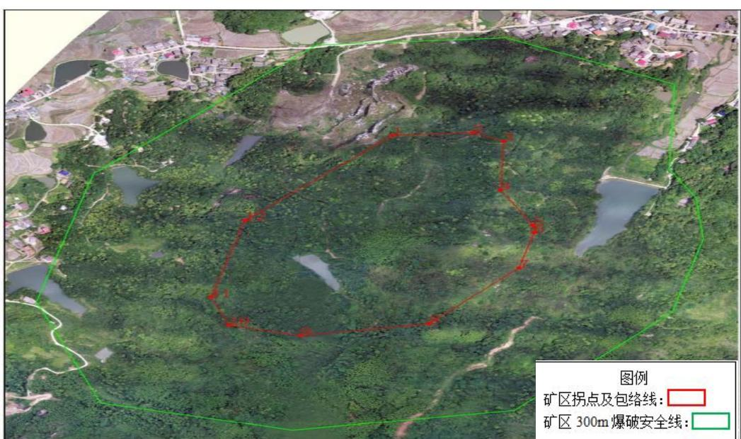
图 3-8 矿区爆破 300m 包络线及周边敏感点分布影像
