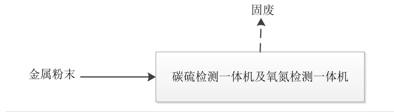
图2.2-3 金属粉末碳硫及氧氮检测工艺流程及产污节点图
